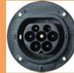
Typ 2 IEC 62196 7-polig 1- und 3-phasig 16 - 63 A 3,7 - 43 kW Steuerkontakte zur Datenübertragung und Kabelerkennung
