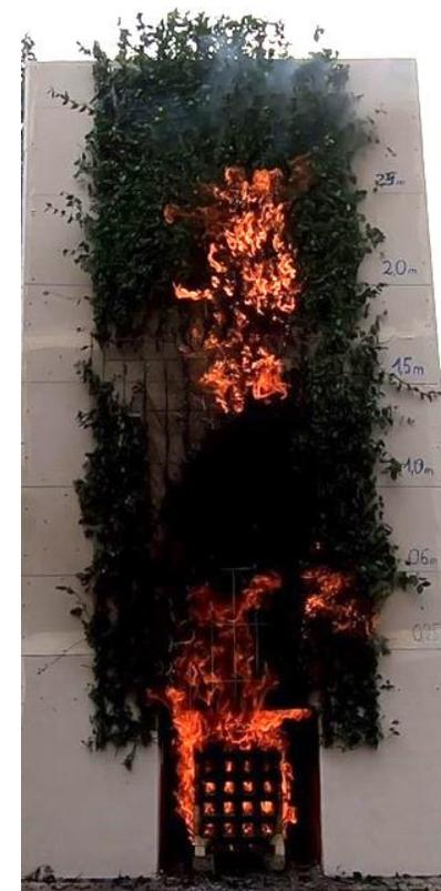
Foto von Julia Noder-Schaab: Brandversuch zur Masterarbeit „Fassadenbegrünung aus brandschutztechnischer Sicht“, TU München, 2019
