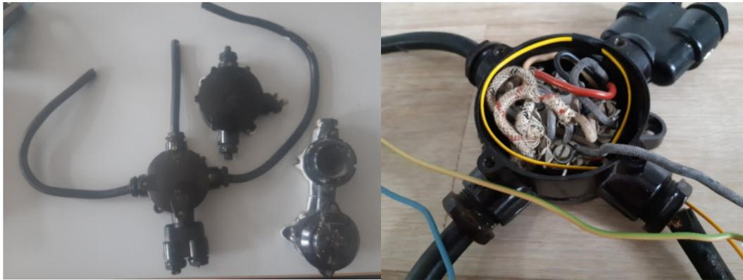
Ausgebaute Bakelit-Elektroinstallation vor 1960 mit Aluminium-Gummiisolierten Leitungen, die im Labor vermessen wurden.
