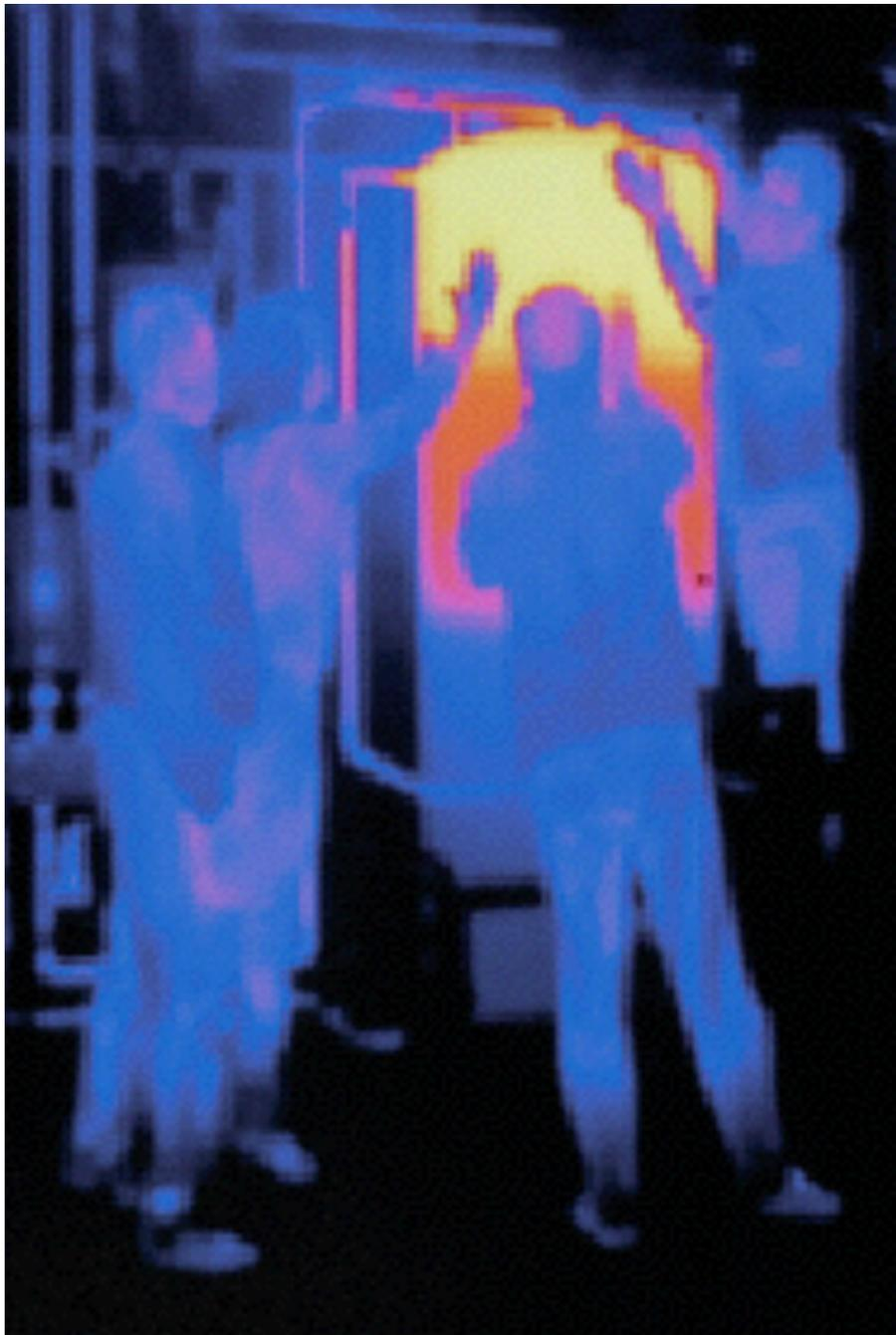
Ob und wie gut ein Speicher oder Schichtspeicher funktioniert, kann einfach und zuverlässig mit Hilfe von Thermographie gezeigt werden.
