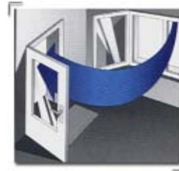
Warme feuchte Raumluft wird durch kühle trockene Außenluft ersetzt.
