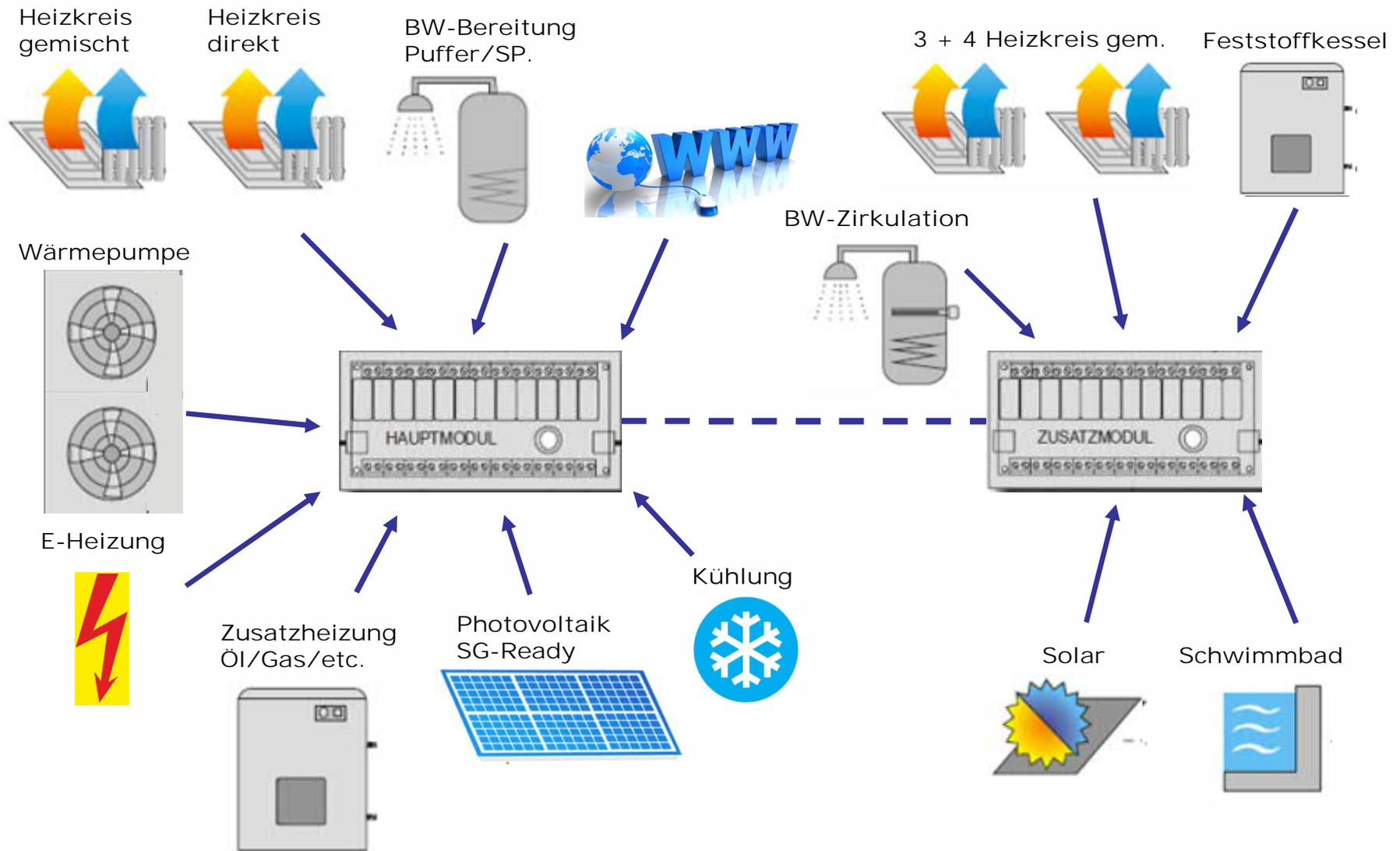
Zusatzmodul: Solar oder Feststoffkessel
