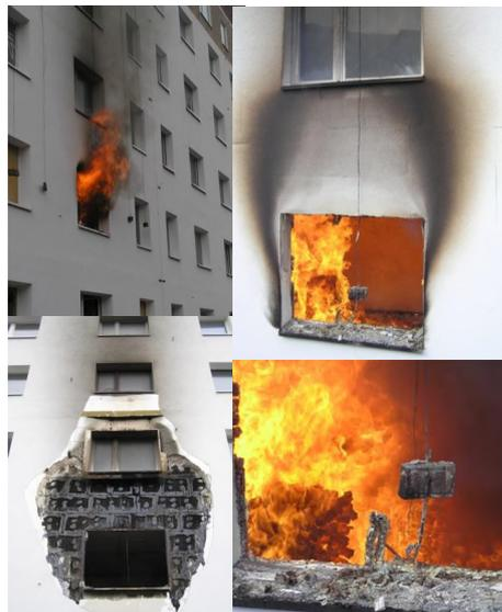
**Ergebnis: Sturzschutz oder umlaufende Brandriegel stellen die Schwerentflammbarkeit von WDVS mit EPS sicher**
