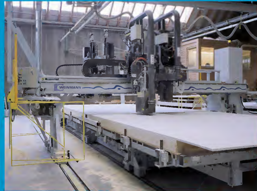
Kaspelung der Tragkonstruktion
