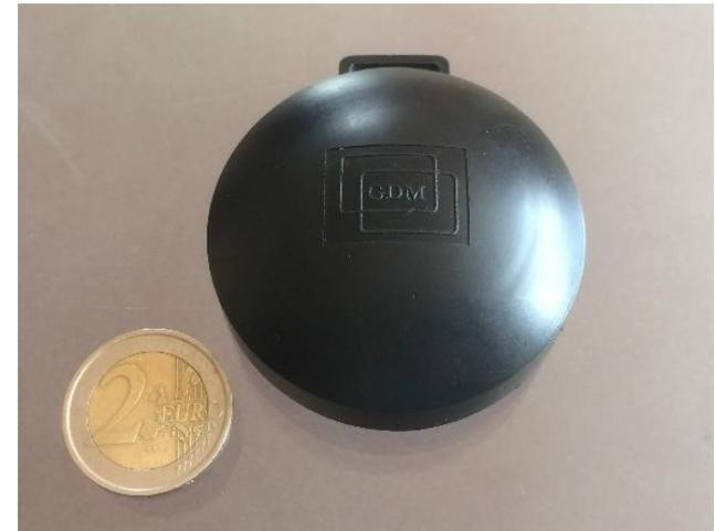
Radon-Detektor im Größenvergleich
