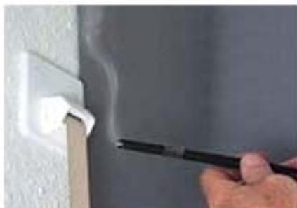
Mit DiHa ESM: jetzt ist die Gurtführung luftdicht.
