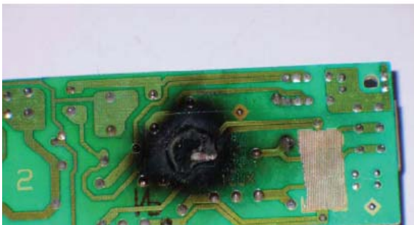
Bild 22: Überspannungsschaden (Quelle Markus Scholand)
