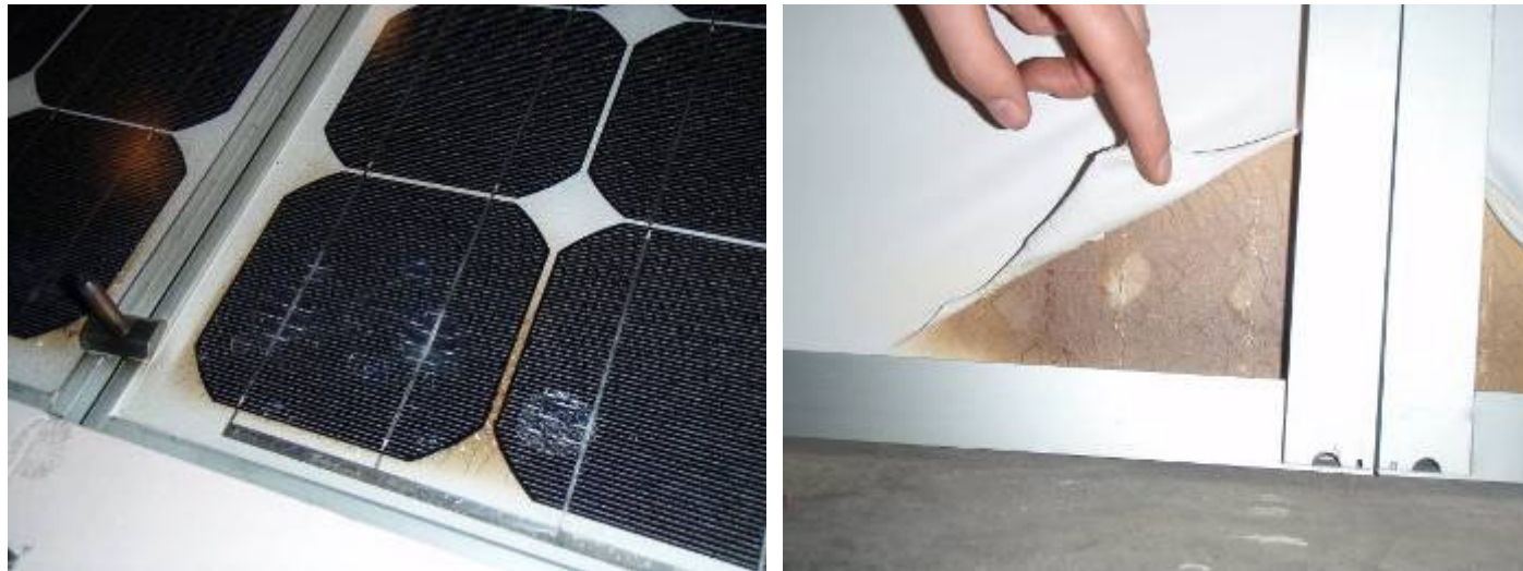
Modulschäden durch Hitzeinwirkung
