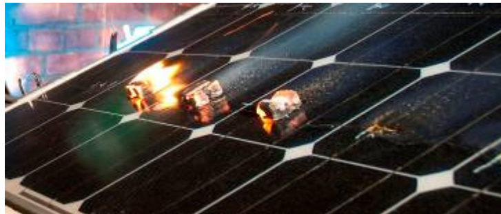
Burning Brand test: Minimumanforderung für PV-Module Klasse C
