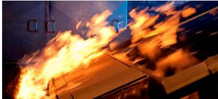
Spread of Flame test: Beflammung der Oberseite der Module
