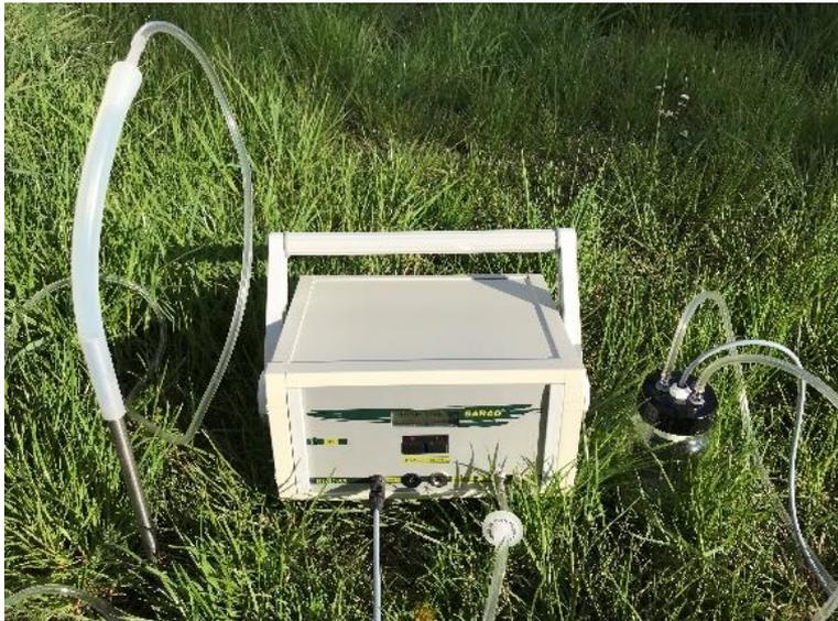
Messgerät RTM 1688-2 mit Bodenluftsonde und Wassereintrittsschutzflasche
