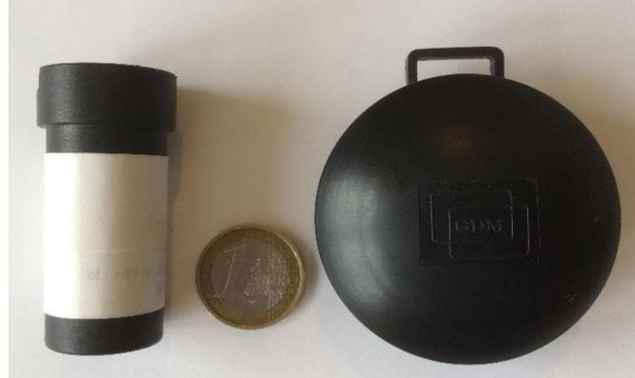
Radon-Detektor im Größenvergleich
