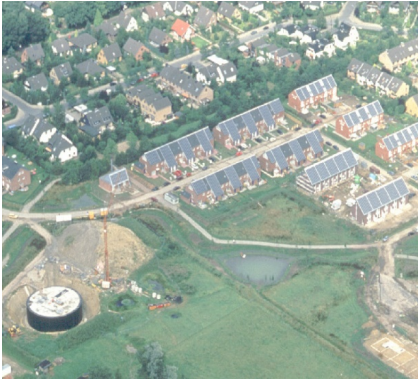
Solare Nahwärme + sais. Wärmesp.
