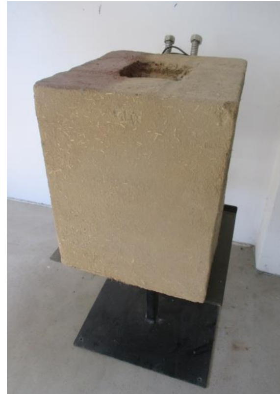
Der erste solartaktivierte Lehmkörper (2010) im Labor des Forum Wohnenergie
