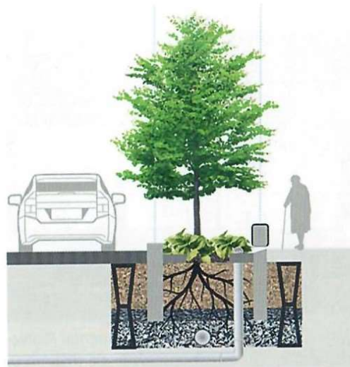
Abb. 5: „Stormwater tree pit“ schematisch („Extended tree pit“ von Jenny Hill. CC BY 4.0, verändert; Quelle: https://wiki.sustainable-technologies.ca/wiki/File:Extended_tree_pit.png )
