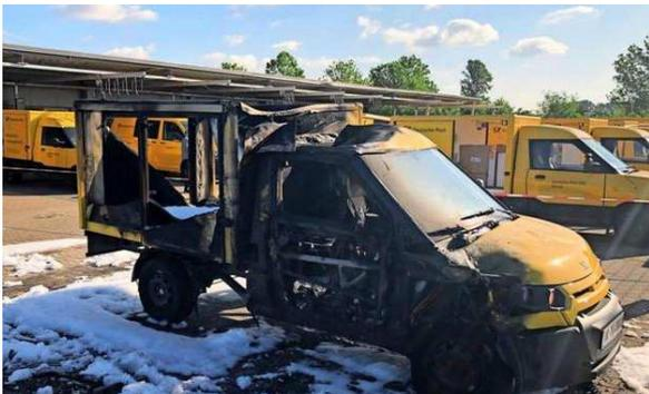
Abbildung 3: Brand eines E-Lieferwagens (Quelle: <https://www.waz-online.de/Nachrichten/Der-Norden/Grossfeuer-an-Verteilzentrum-Sechs-E-Scooter-ausgebrannt> [04.08.2020])
