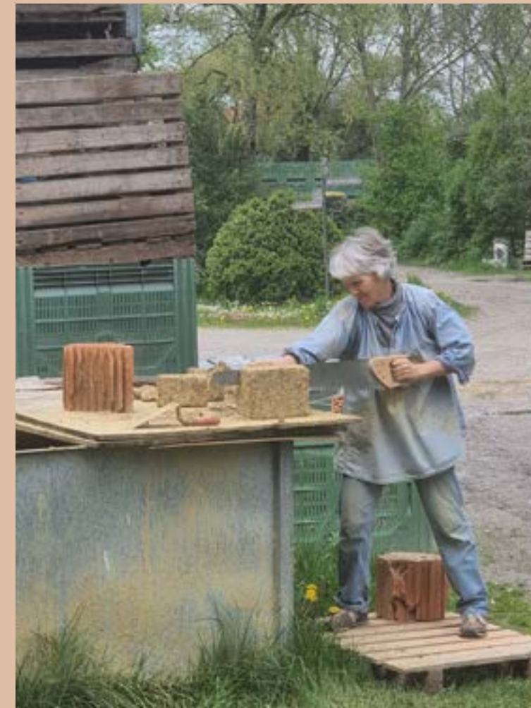
LEICHTLEHMSTEINE LASSEN SICH MIT DER GASBETON-SÄGE ZUSCHNEIDEN
