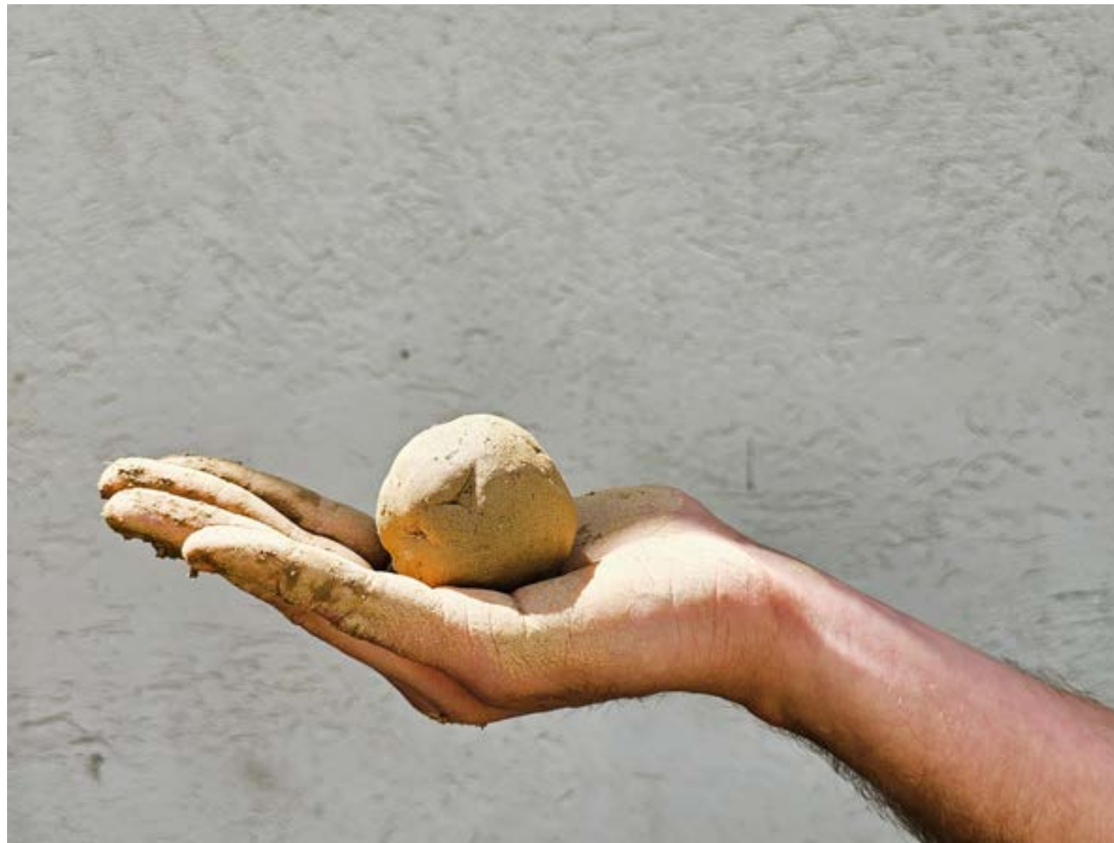
BEISPIEL FÜR EINE FELDPRÜFUNG: KUGELFORMPROBE
