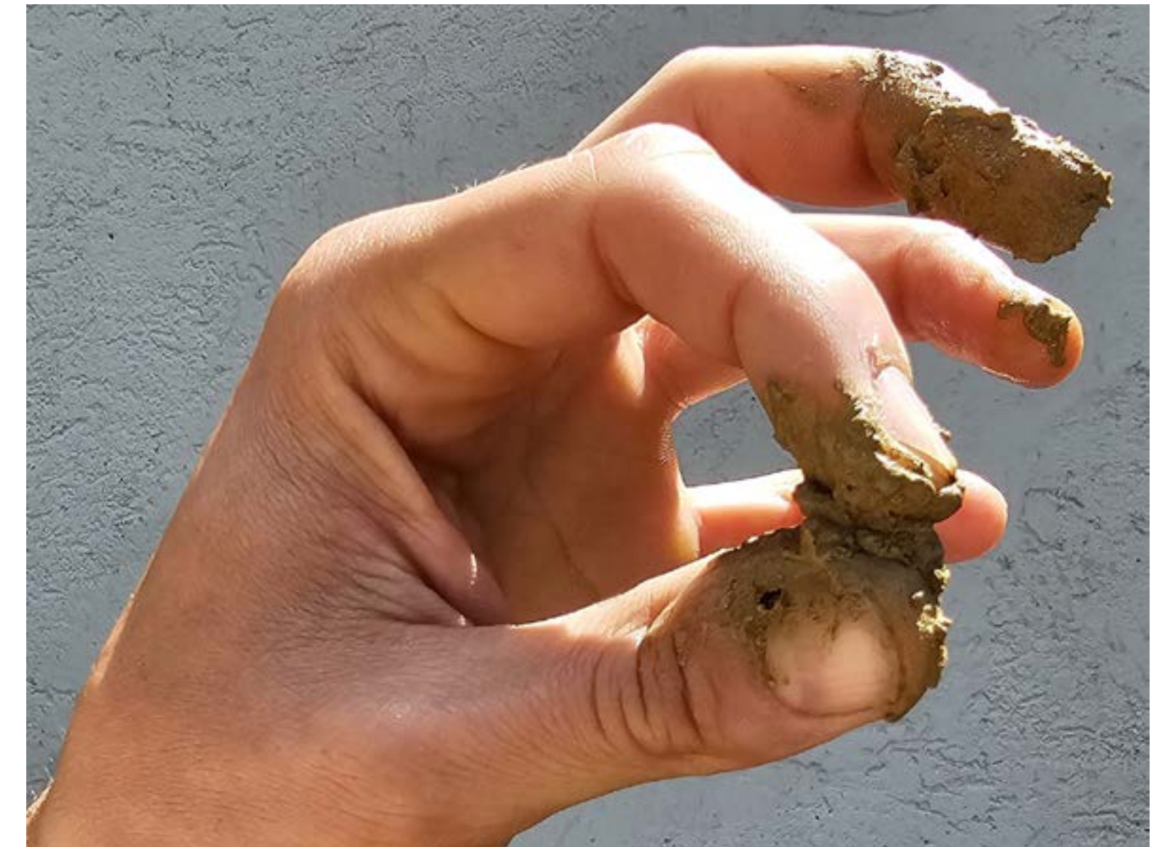
BEISPIEL FÜR EINE FELDPRÜFUNG: REIBE- UND WASCHVERSUCH
