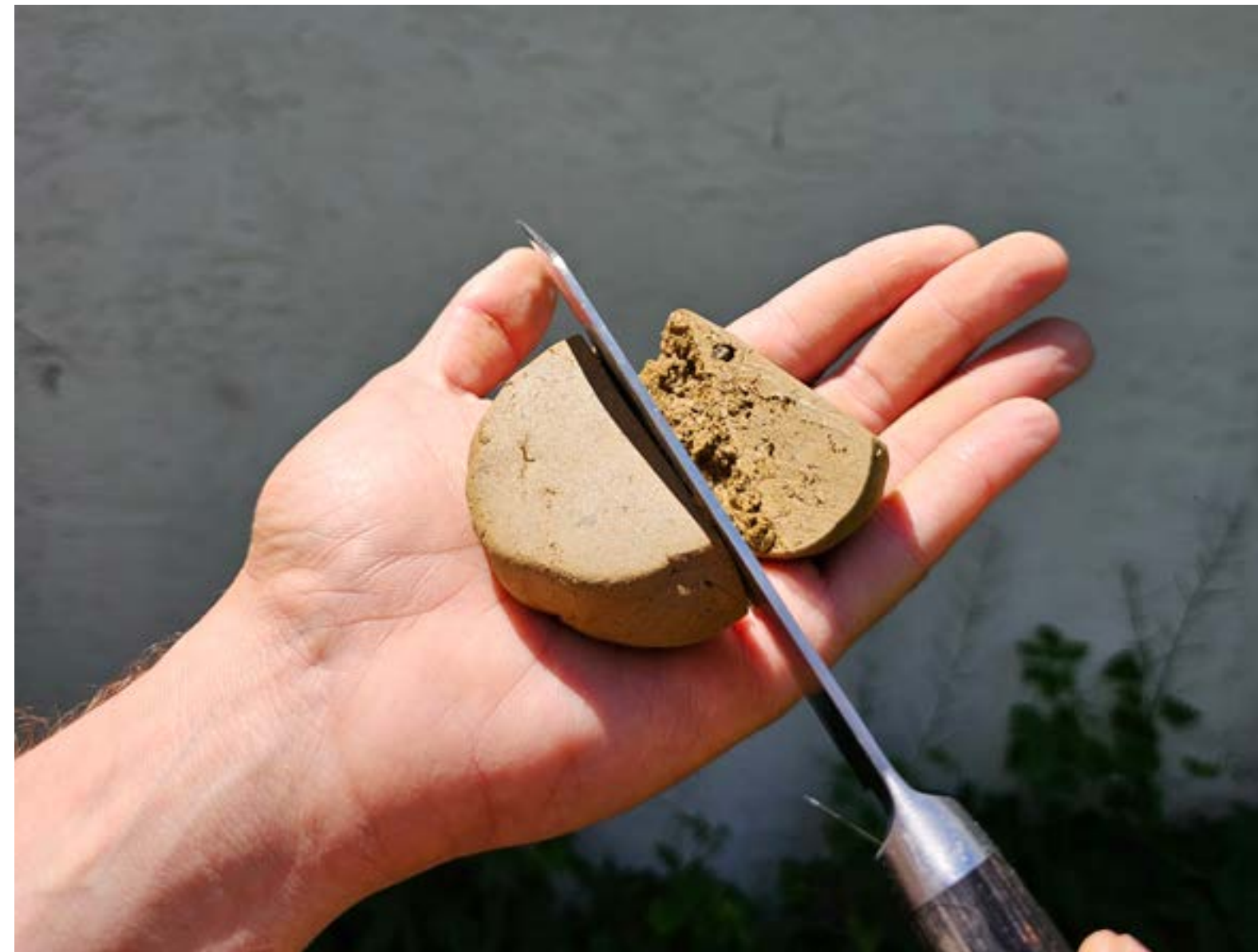
BEISPIEL FÜR EINE FELDPRÜFUNG: SCHNEIDEVERSUCH
