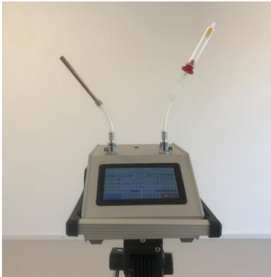
Luftprobensammler BiVOC2V2 (Holbach Messtechnik) mit Medien. Links: Tenax-Röhren, rechts: DNPH-Kartusche
