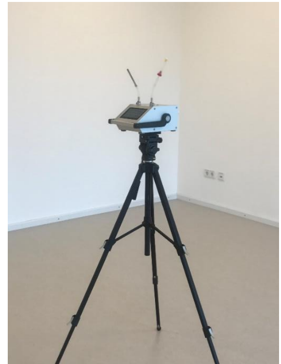
Luftprobensammler BiVOC2V2 (Holbach Messtechnik) mit Medien. Links: Tenax-Röhren, rechts: DNPH-Kartusche
