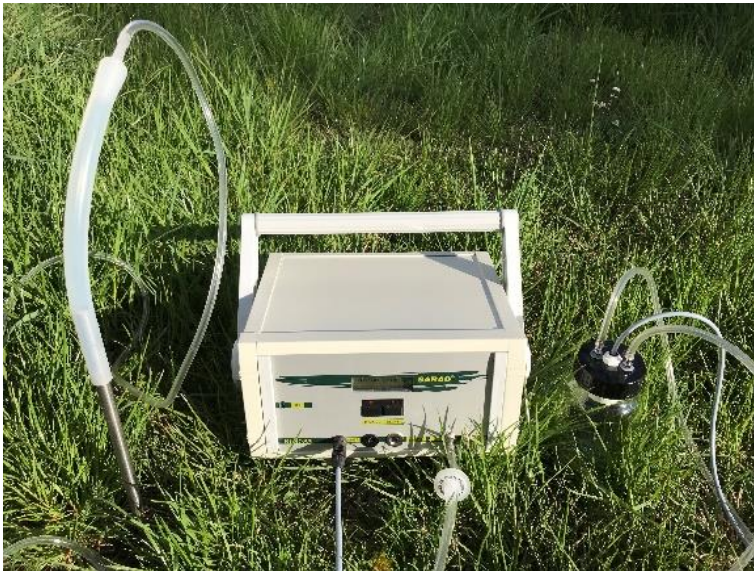
Messgerät RTM 1688-2 mit Bodenluftsonde und Wassereintrittsschutzflasche
