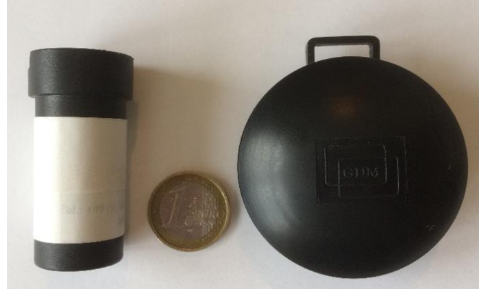
Radon-Detektor im Größenvergleich (verschiedene Hersteller)
