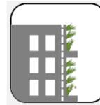
Fassadenbegrünung der Nord-, Ost- und Westfassaden mit Hilfe von Rank- und Kletterhilfen sowie fassaden-integrierten Pflanzträgern, Löschanlage an Kaifassade
