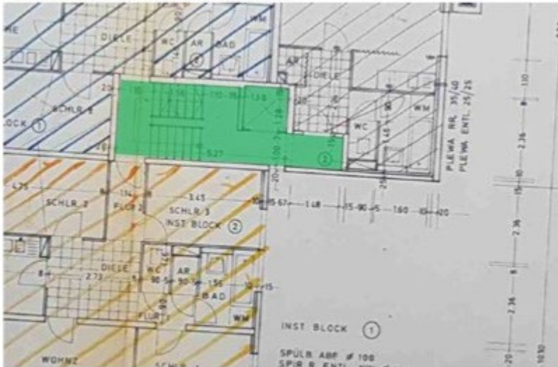
Abbildung 3: Exemplarische Darstellung eines notwendigen Treppenraums in einer Gebäudeinnenecke Quelle: Bestandsunterlagen Haus A 1970.
