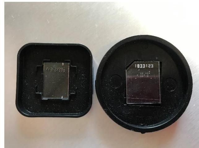
Geöffneter Radon-Detektor, Detektorfläche, Auswertung im Labor
