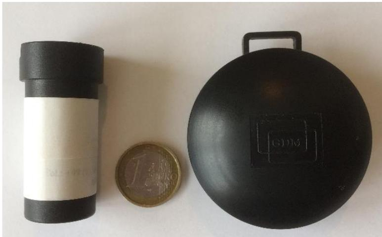
Radon-Detektoren unterschiedlicher Hersteller im Größenvergleich mit einer Münze
