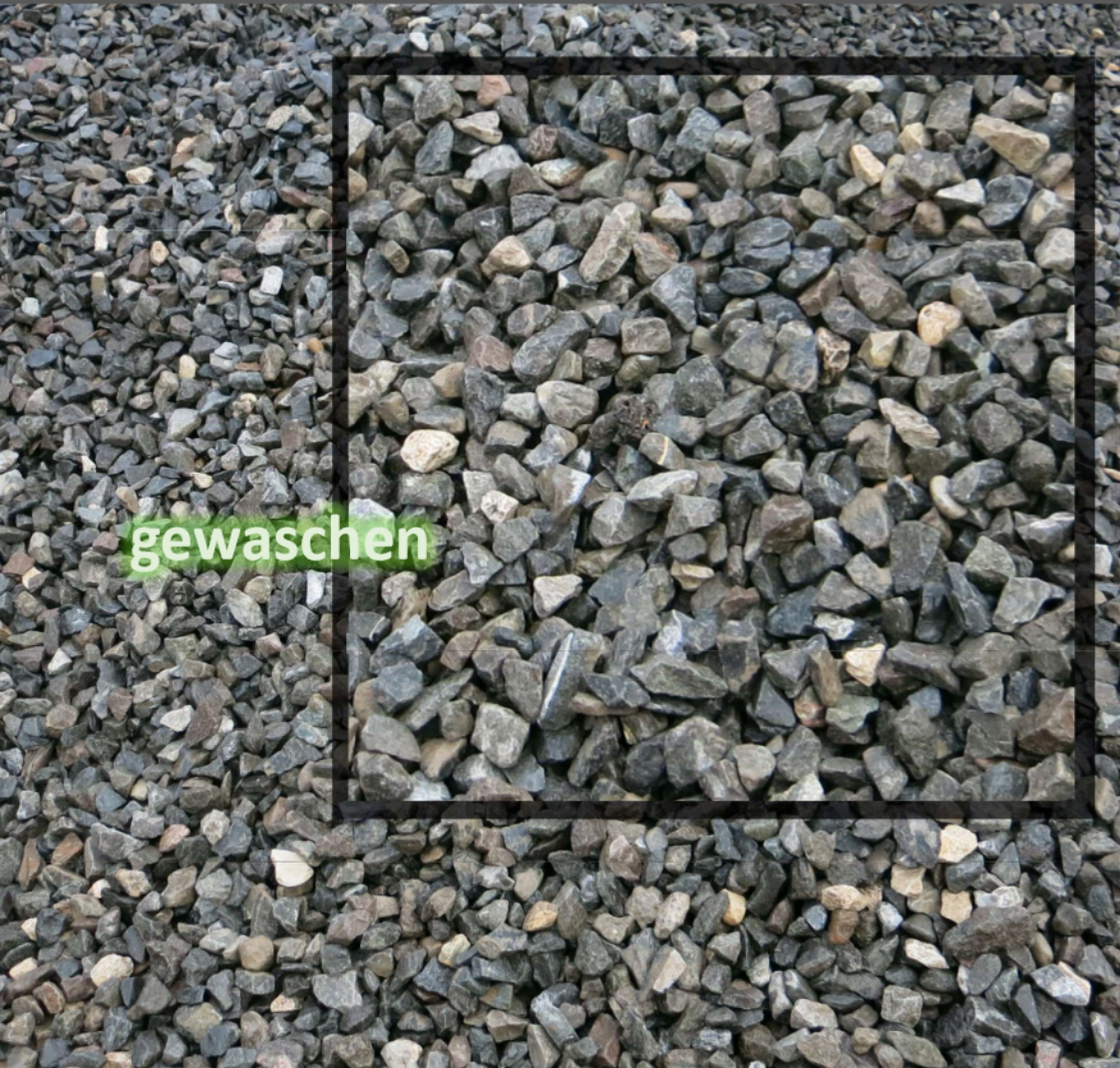
Gleisschotter 31,5/63 (Granit- & Basaltmaterial)
