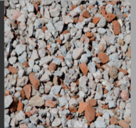
Zuschlag- stoff für R-Beton
