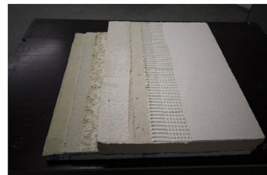
Musterplatte mit Schaummörtel und Leichtputzmörtelproben
