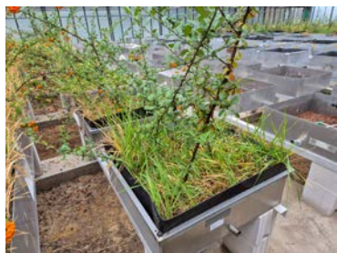
Prüfung der Wurzel- und Rhizomfestigkeit von Dachbahnen
