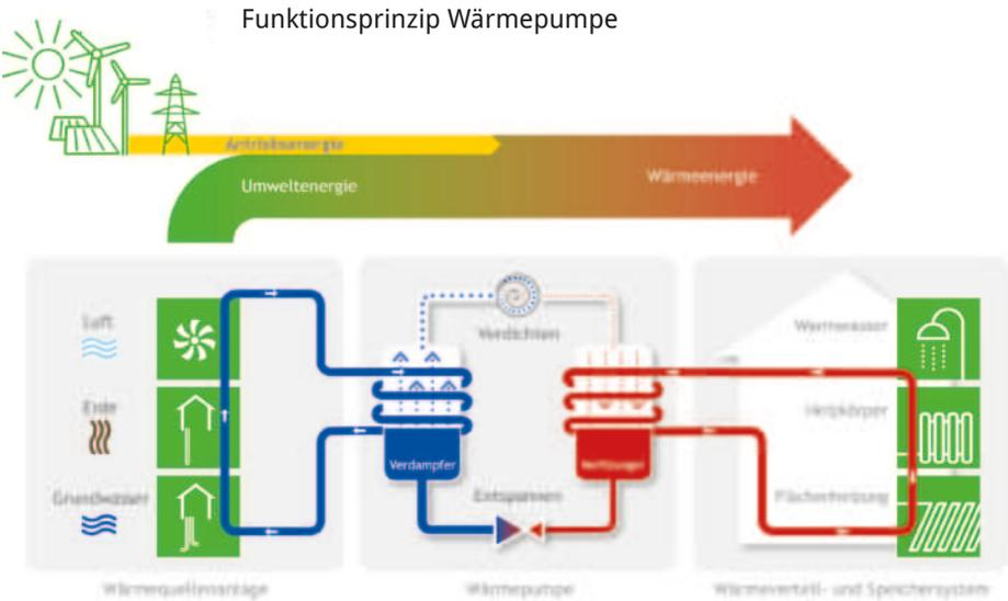
Eine Wärmepumpen-Heizungsanlage besteht aus drei Teilen: der Wärmequellenanlage, die der Umgebung die benötigte Energie entzieht, der eigentlichen Wärmepumpe, die die gewonnene Umweltwärme nutzbar macht sowie dem Wärmeverteil- und Speichersystem, das die Wärme im Haus verteilt oder zwischenspeichert.
