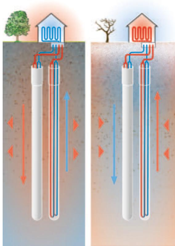
Heizen und Kühlen mit der Wärmepumpe
