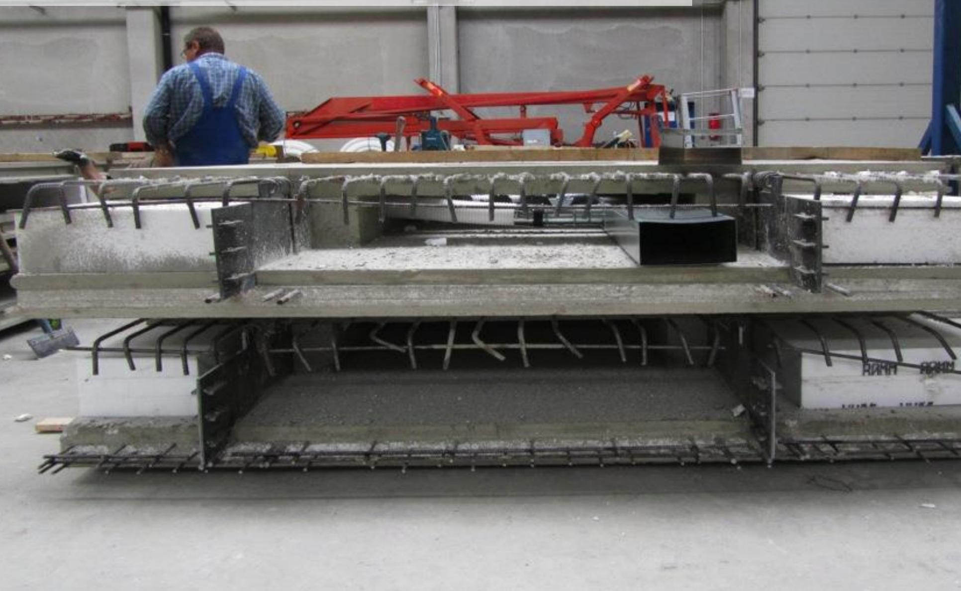
**Vorgefertigte Betonelemente:** alle Komponenten der Haustechnik werden bereits im Fertigteilwerk installiert und auf der Baustelle miteinander verbunden
