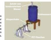
Bild 3: Abfüllanlage am Trinkwassertank mit PET-Flaschenabfüllung
