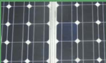
PV-Module mit Zellverfärbung
