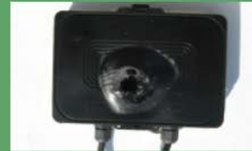
Verschmorte Anschlussdosen außen
