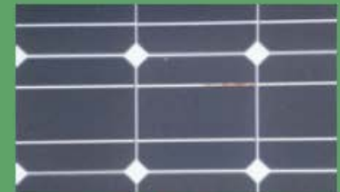
Verfärbung der Zellverbinder
