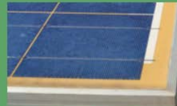
Verfärbungen der Rückseitenfolie
