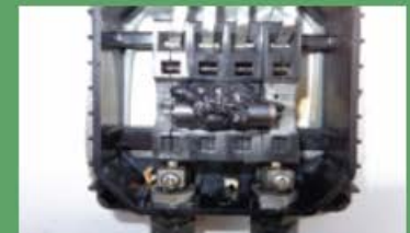
Verschmorte Anschlussdosen innen
