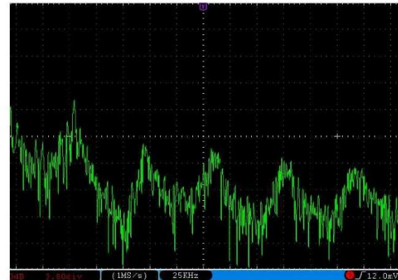
Helligkeitsverlauf eines LED-Leuchtmittels (Flimmeranteil 100%, Flimmerfrequenz 49 kHz)
