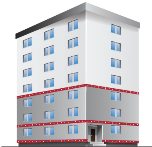
Dämmdicke: d \leq 300 mm EPS mit Putzbeschichtung
