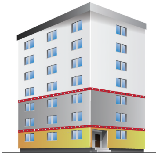
Dämmdicke: 40 \text{ mm} < d \leq 200 mm EPS mit „harten Belägen“ oder auf Holzuntergrund
