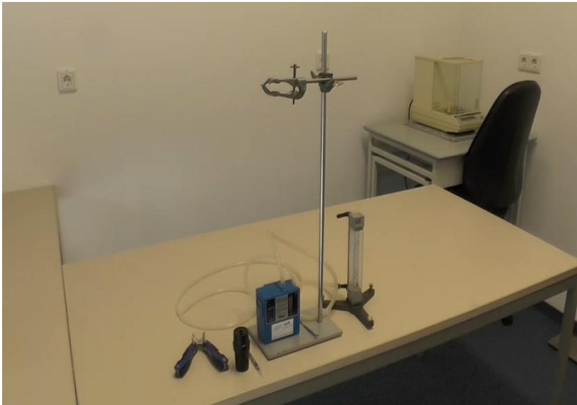
Bild 1: Stativ, Pumpe, Volumenstrommesser
