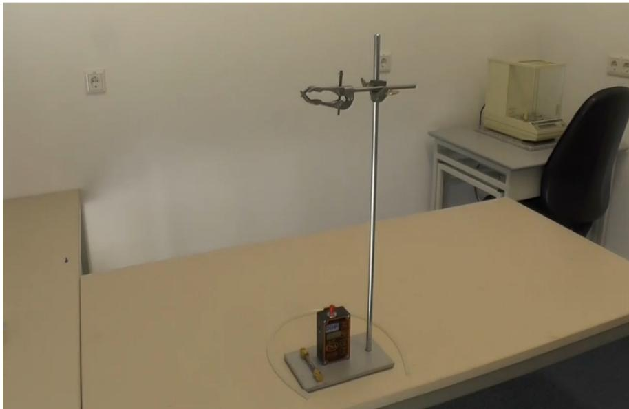
Bild 3: Stativ, TENAX-Pumpe, Schlauch und Adsorbens
