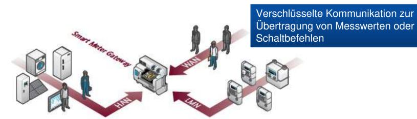
Anbindung von steuerbaren Geräten des Letztverbrauchers über CLS-Schnittstelle, z.B. Speicher oder PV-Anlage sowie Schnittstelle für Servicetechniker Senden der Verbrauchs- und Einspeisewerte von Messeinrichtungen an das Gateway
