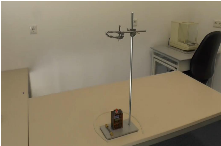
Bild 3: Stativ, TENAX-Pumpe, Schlauch und Adsorbens
