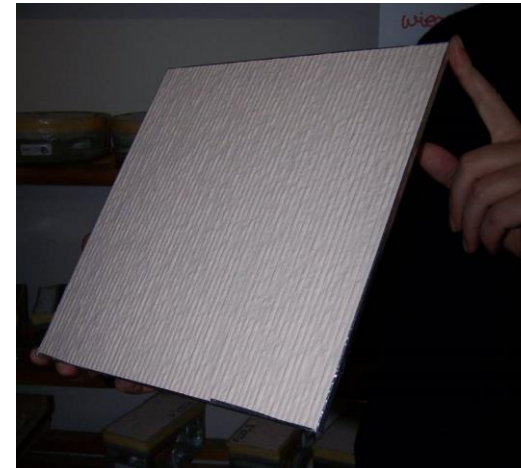
Feuchtepuffernde Fliesen in kontrollierter Klimakammer
