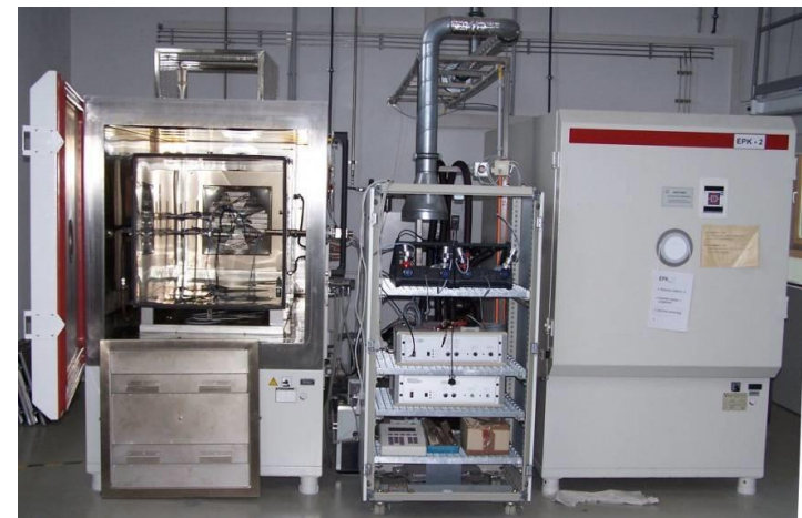
Feuchtepuffernde Fliesen in kontrollierter Klimakammer
