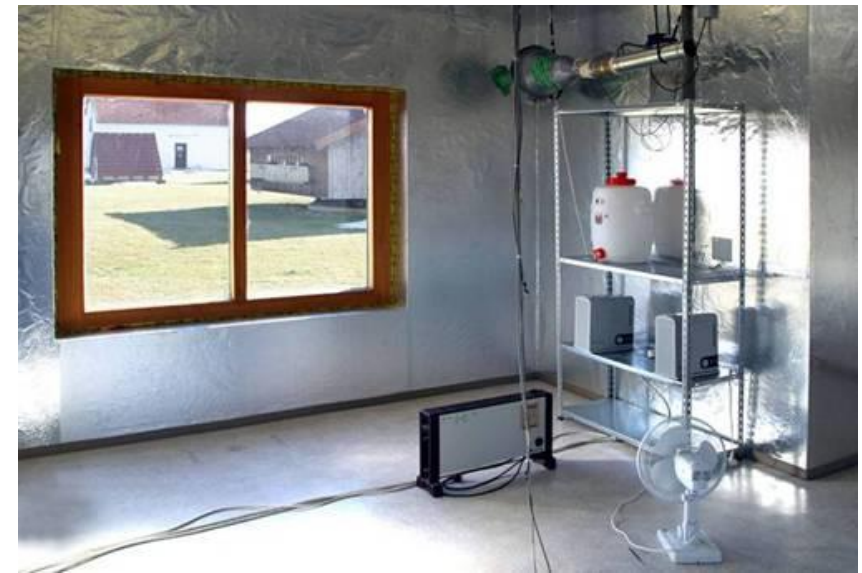
Testraum mit Aluminium ausgekleidet
