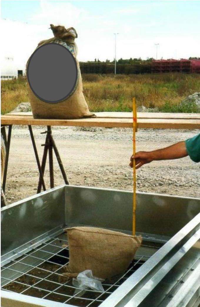
Lichtkuppeln sind erst einmal als nicht durchsturzsticher anzusetzen. Wer bereits beim Bau darauf achtet, dass z.B. mit fest eingebautem Gitter gearbeitet wird, spart sich später Kosten für Umwehrungen, Abdeckungen, Innennetze etc.
