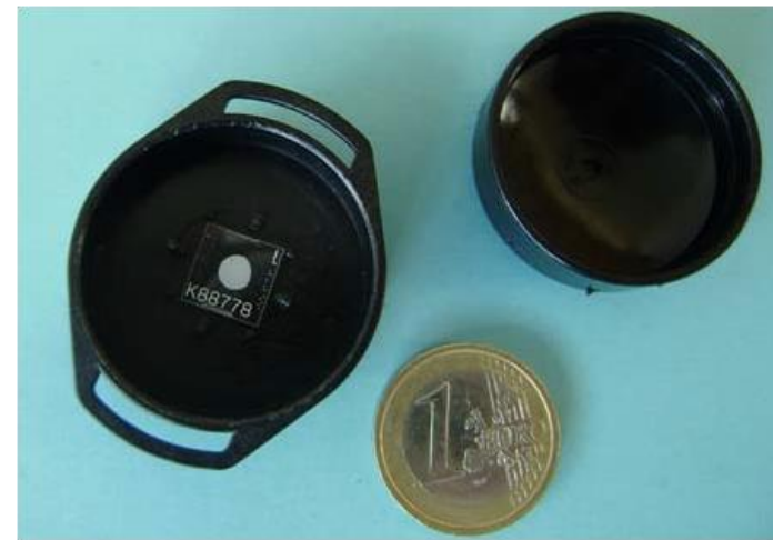
Geöffneter Radon-Detektor, Detektorfläche: kleines Kunststoff-Plättchen, das durch radioaktive Zerfälle „Mikroeinschläge“ bekommt, Auswertung im Labor
