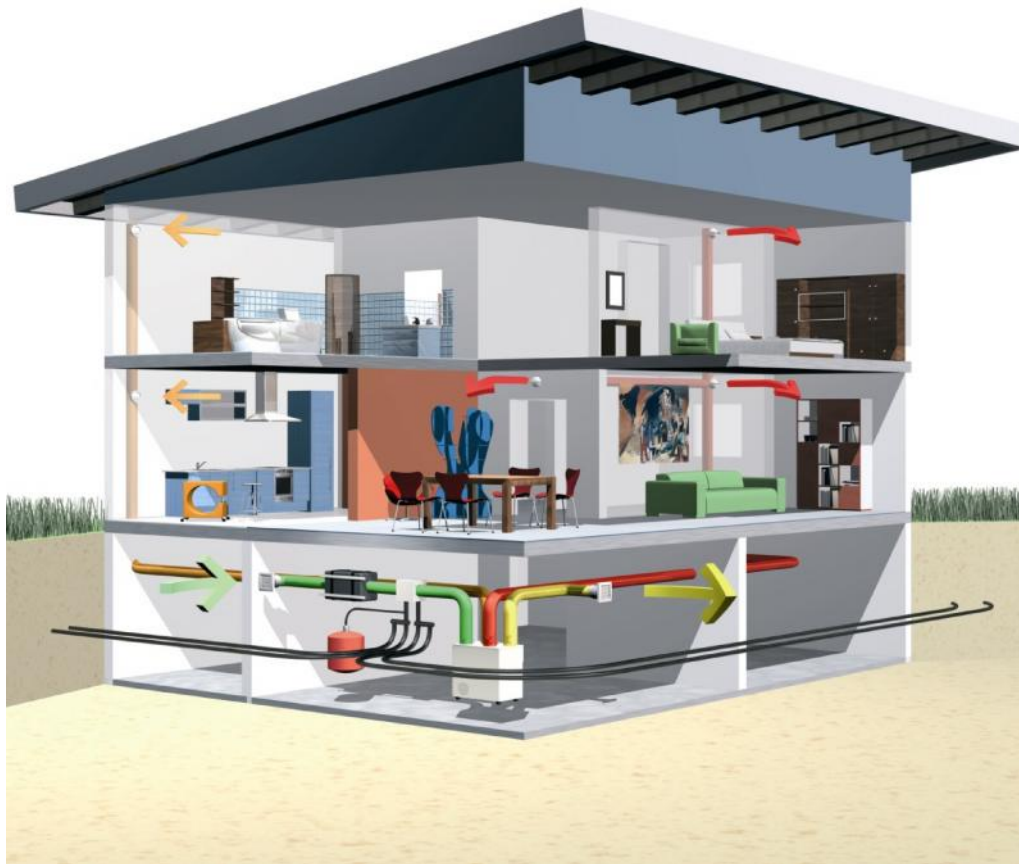
Funktionsschema Lüftungssystem mit WRG im EFH-Haus
