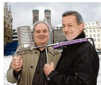
Marke Eigenbau: Umweltreferent Joachim Lorenz und Tobias Fuchs vom Deutschen Wetterdienst zeigen ihr Messgerät. Der Blechturm links simuliert Hitze im Schatten, kleinere Aufbauten messen, wie die Sonne auf helle und dunkle Kleidung sowie auf nackte Haut brennt.
