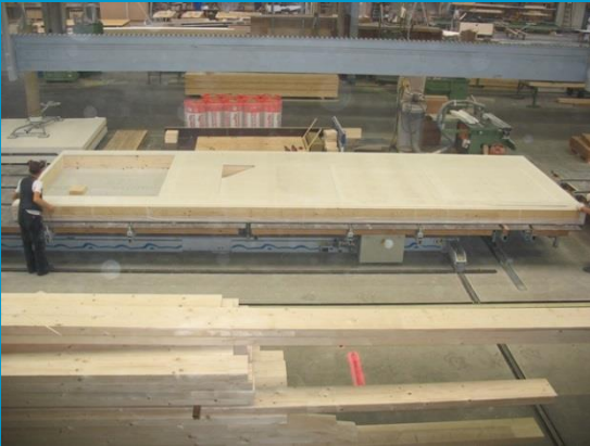
Herstellung von großflächigen Wandelementen
