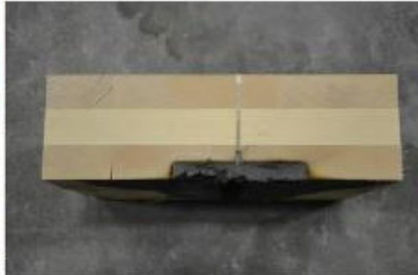
Abbildung 3-32 rechts das Wandelement aus Brettsperrholz nach Abbau der Bekleidung, die schwarzen Verfärbungen stammen von Resten des aufgeschäumten Brandschutzanstriches. Links ein horizontaler Schnitt durch
