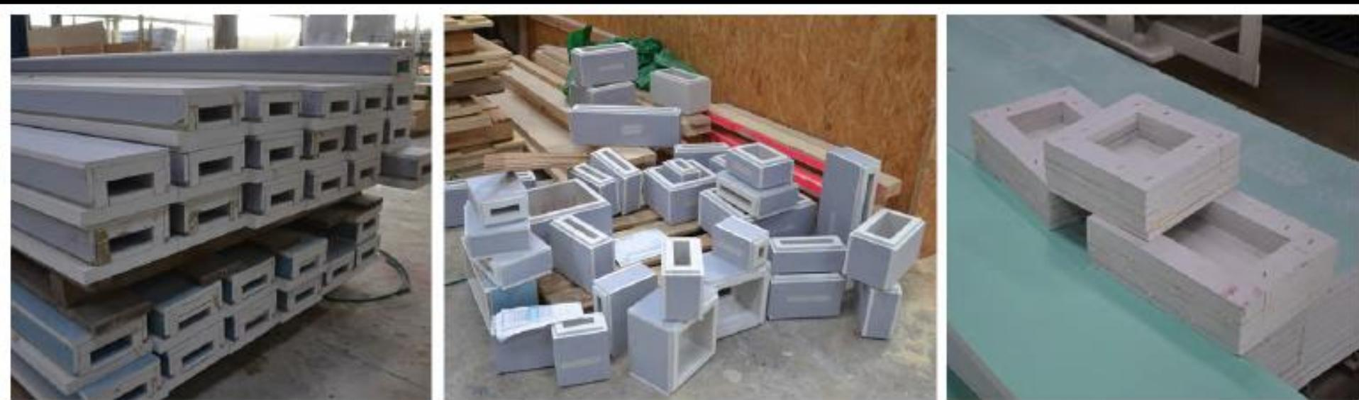
Abbildung 2-11 Praxisbeispiele für zusätzliche Gipsplattenkästen zum Einbau von Elektroinstallationen
