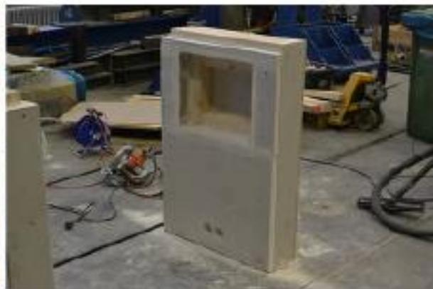
Abbildung 3-27 V4: links das Wandelement aus Brettsperrholz mit Brandschutzanstrich und Elektroinstallationen, rechts das Holzständerwandelement mit dem eingebauten Holzrahmen
