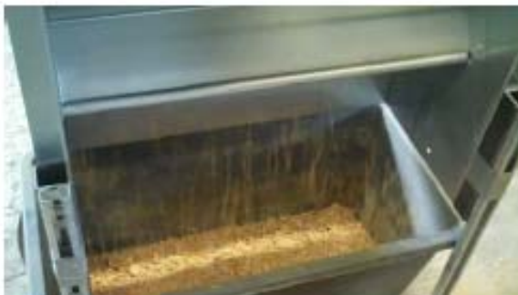
Keramikbruch nach Windsichtung im Zig-Zag-Sichter → Wiederverwendung siehe weiter Folien
