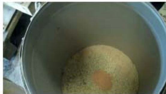
Dämmstoffanteil nach Absaugung im Windsichter → Wertstoff zur Wiederverwendung
