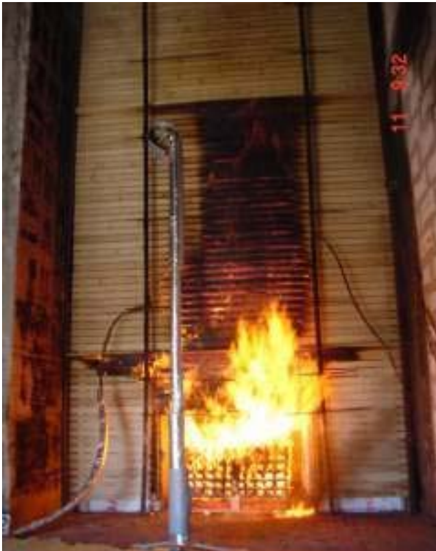
Brandversuch im Fassadenprüfstand MFPA Leipzig
