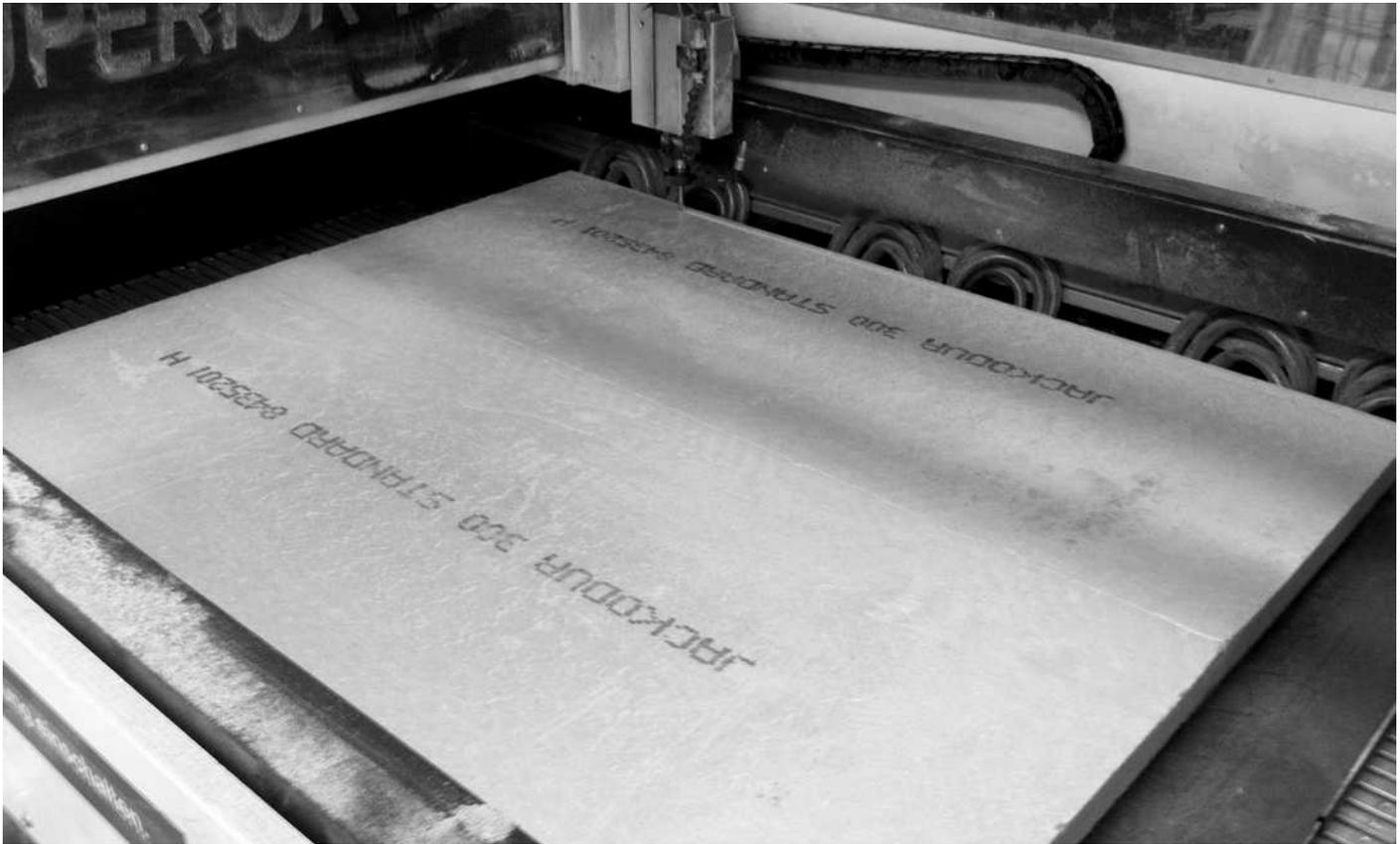
Die 3-Achs Fräse bearbeitet das Styrodur
