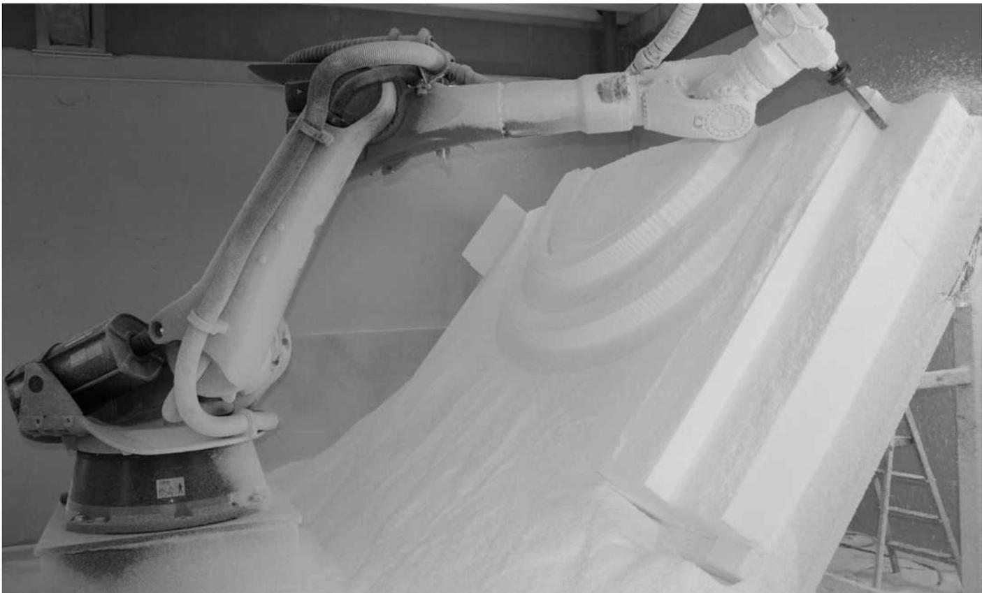
Abb 4 Ein Schalungselement wird gefräst
