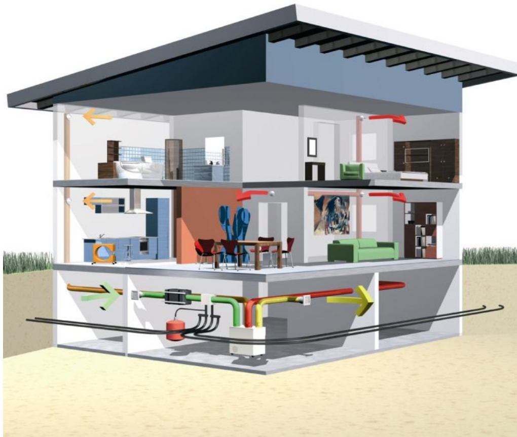
Funktionsschema Lüftungssystem mit WRG im EFH-Haus
