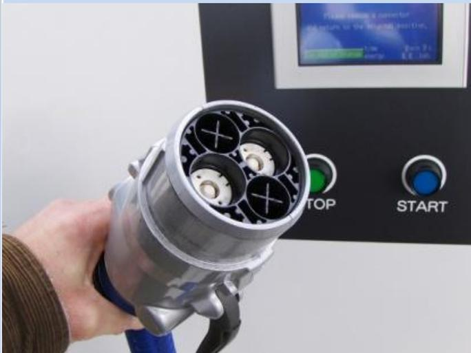
Vor allem in Japan, Nordamerika; zunehmend auch in Europa eingesetzt. Wird u.a. von Mitsubishi, Nissan, Toyota und Subaru verbaut sowie dem Stromversorger TEPCO. Ladesystem für Schnellladung mit hohen Gleichströmen, welche von der Ladestation direkt in die Traktionsbatterie gespeist werden. Ladeleistung von typisch 50 kW bis 62,5 kW.
