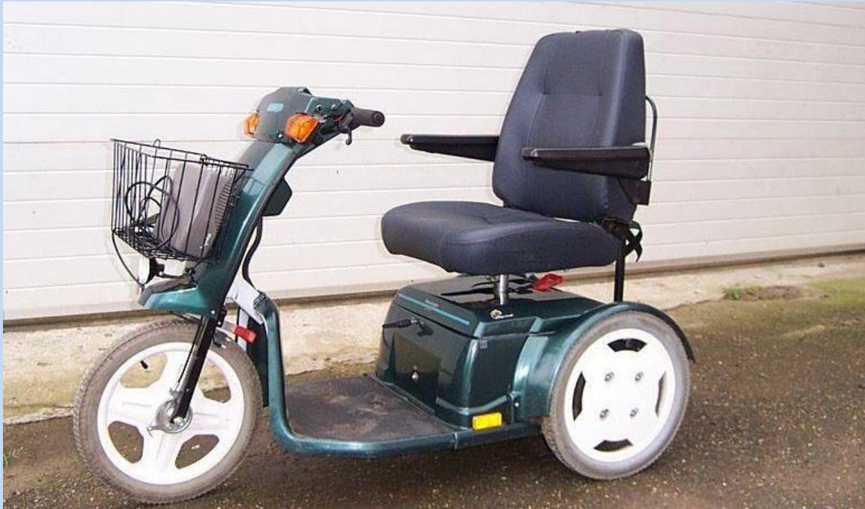
**Elektromobil:** Kleines, offenes, elektrisch angetriebenes Leichtfahrzeug, welches nur den Fahrzeugführer befördern kann und meist von Gehbehinderten genutzt wird.
