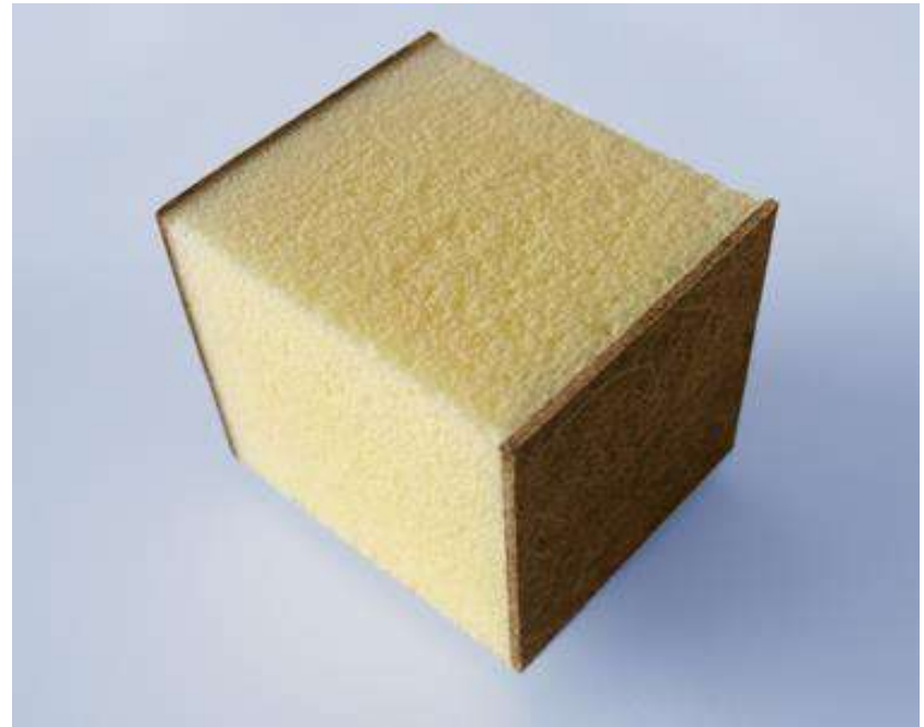
Sandwichkonstruktion - Leinöl Epoxid im Stützkern und als Matrixmaterial in den Sandwichdeckschichten
