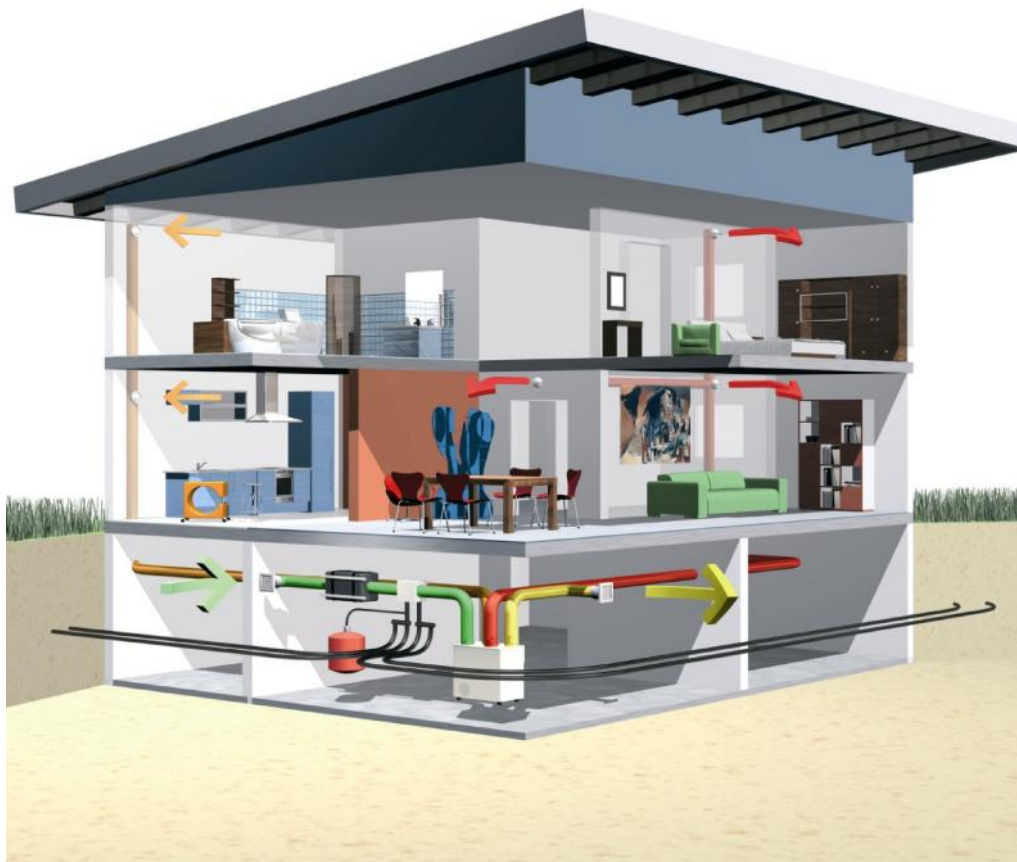
Funktionsschema Lüftungssystem mit WRG im EFH-Haus
