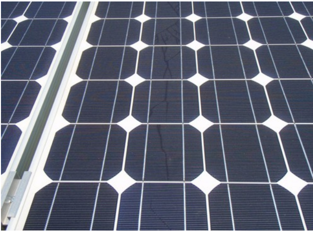
Schnecken Spuren (Mikrorisse)
