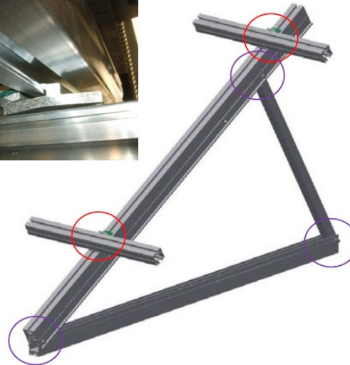
Knotenpunkte der Aufständersdreiecke
